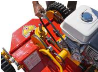
PASO 4 : Coloque la correa nueva en la polea del motor.
