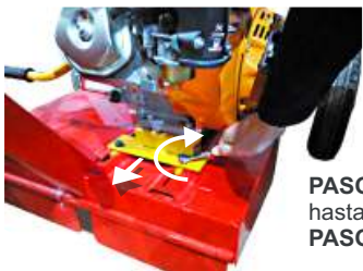
PASO 4 : Coloque la correa nueva en la polea del motor.
