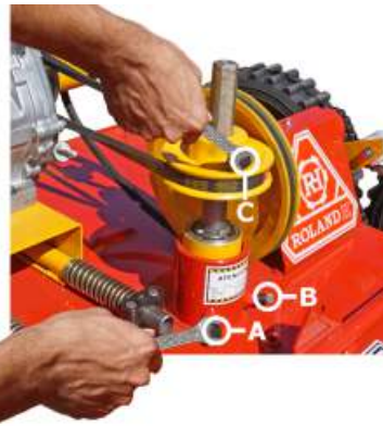
PASO 2: Desplace manualmente el motor hacia adelante. PASO 3: Retire la correa.
